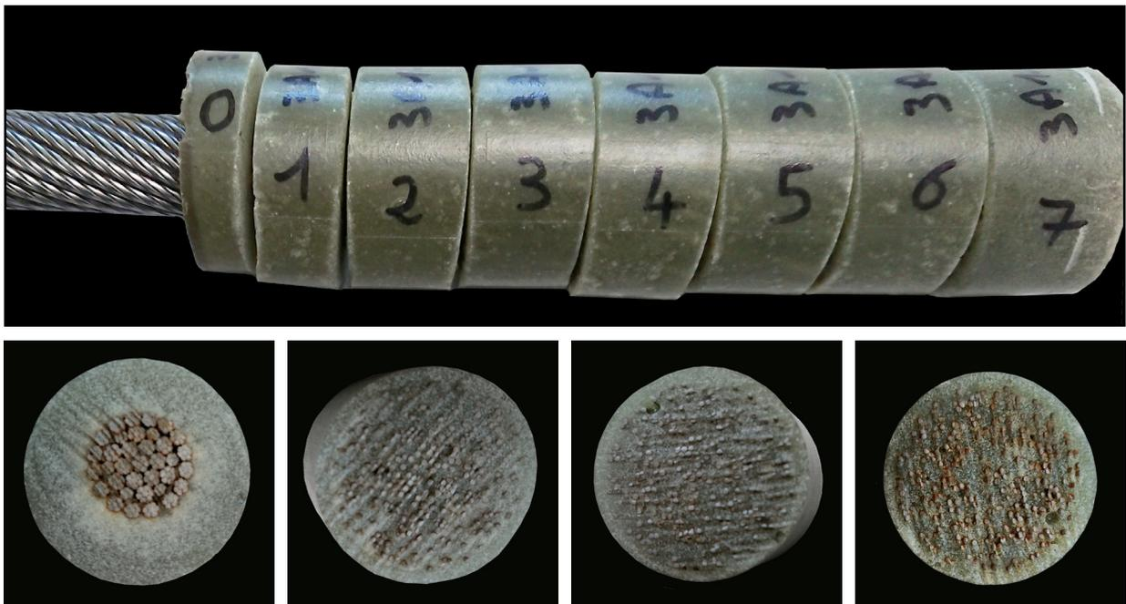
Fig. 89: Répartition des fils à l'intérieur du manchon coulé en différentes sections
