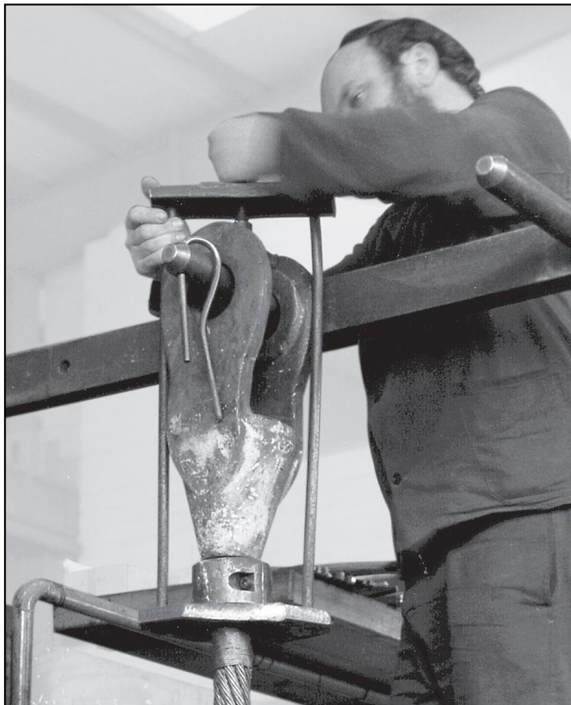
Fig. 70: Ajustement de la position du corps du culot
