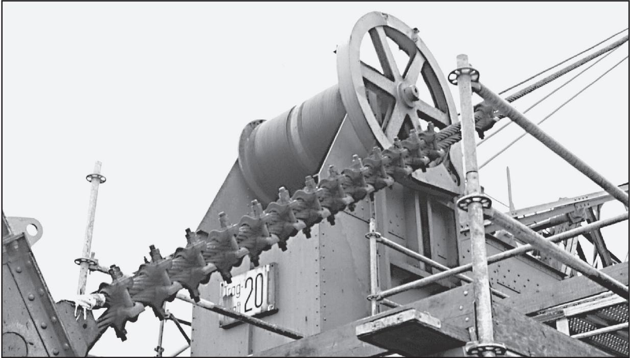
Fig. 12: Terminaison réalisée avec des serre-câbles pour application minière
