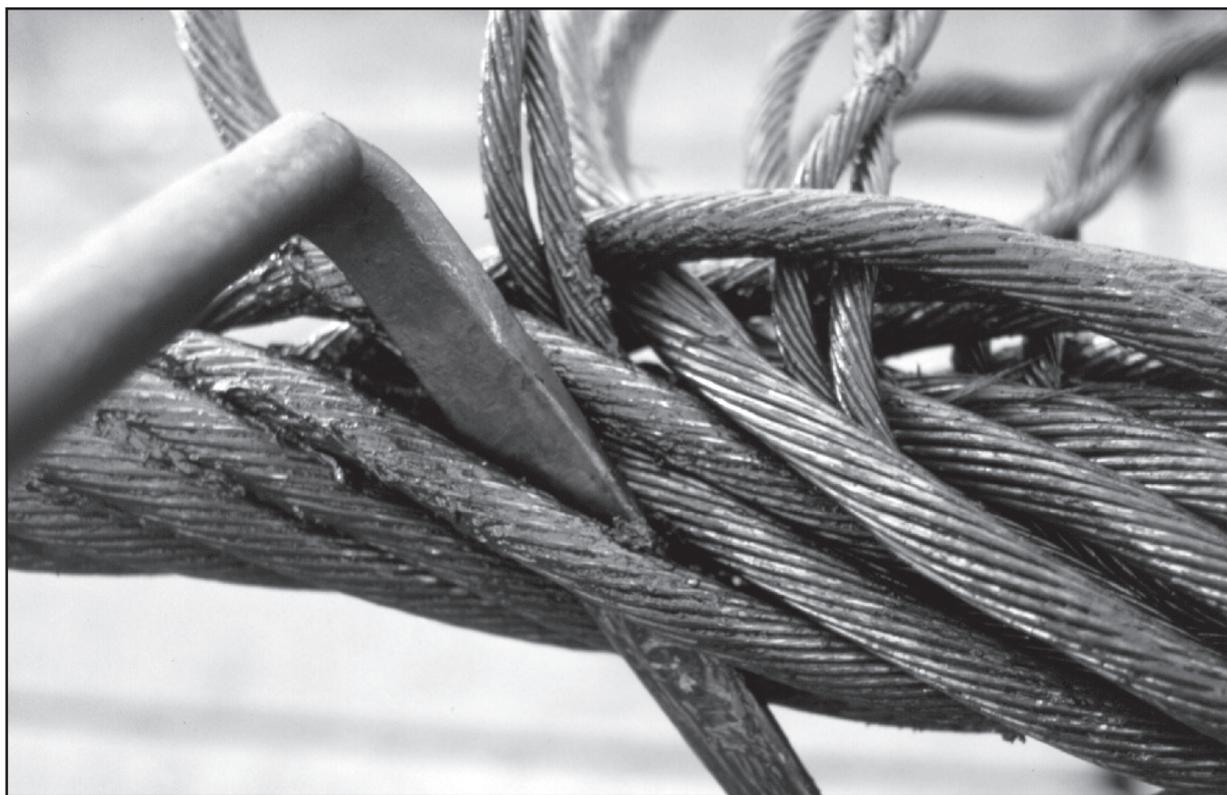
Fig. 33: Epissure d'un câble huit torons avec âme métallique (détail)
