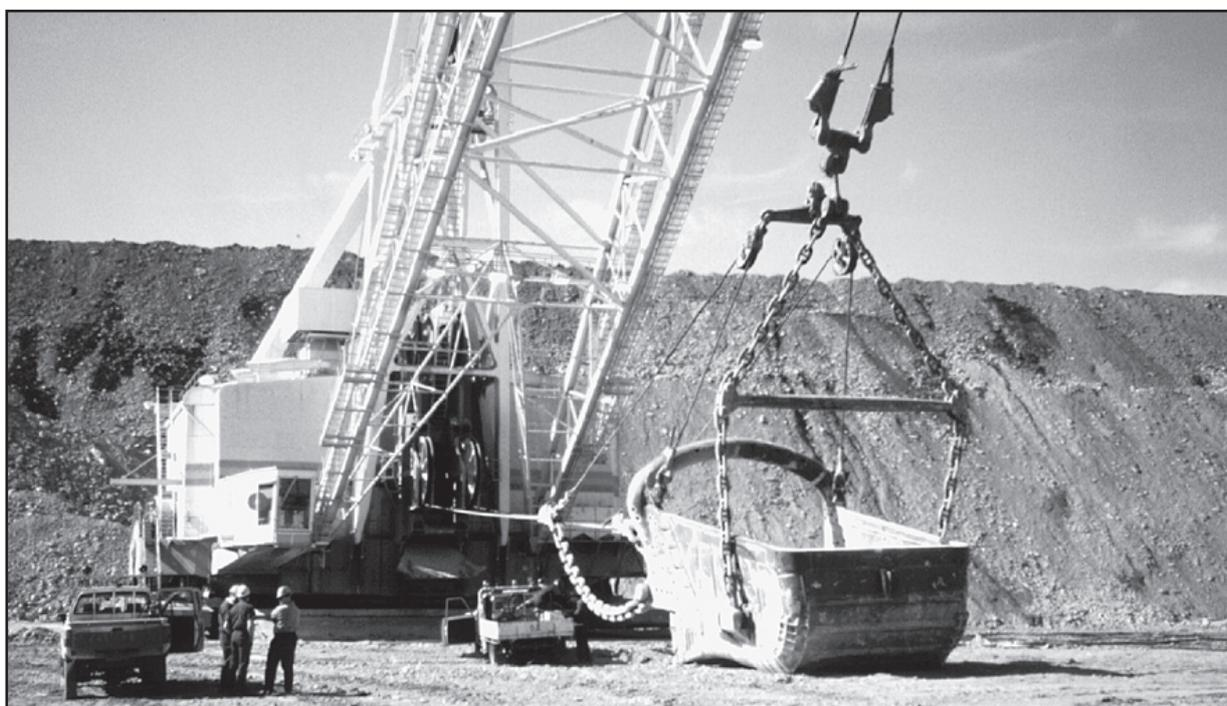
Fig. 22: Boîtes à coin montées sur une dragueline
