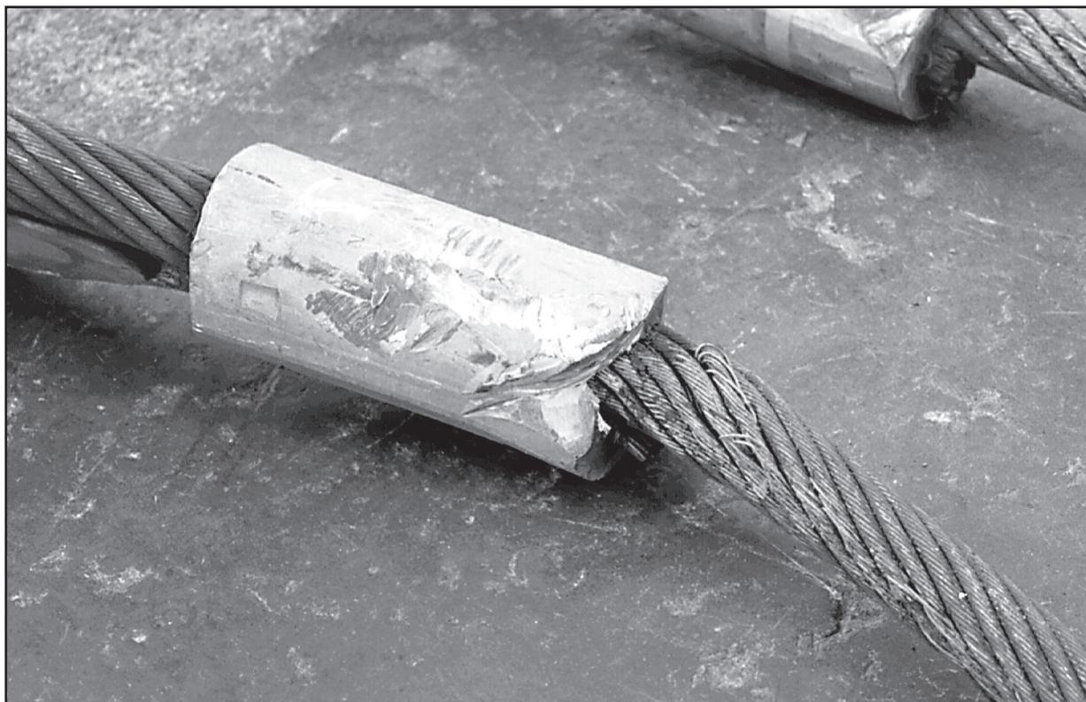
Fig. 50: Endommagement d'un manchon aluminium
