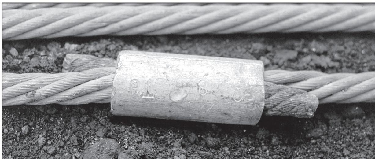
Fig. 49: Type de raboutage interdit
