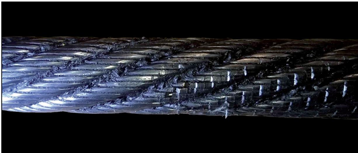
Fig. 86: Câble acier qui a été installé dans l'attache sans manchon coulé
