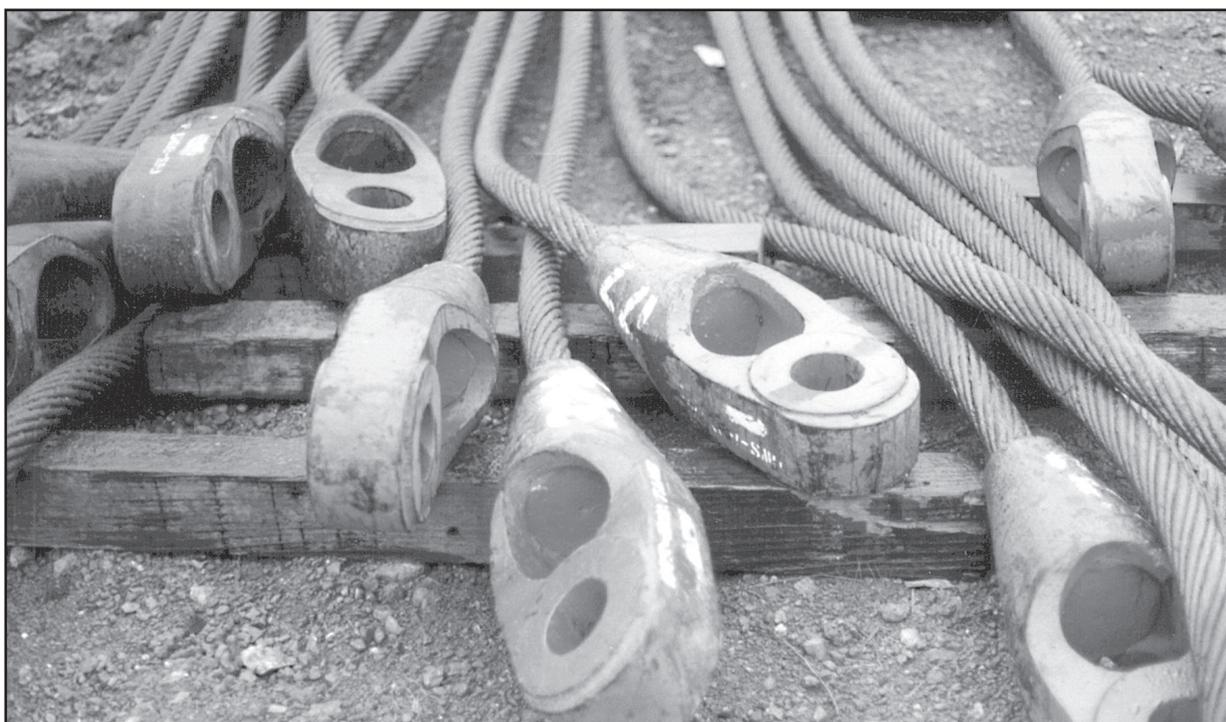
Fig. 61: Câbles de suspension pour grues à flèche treillis
