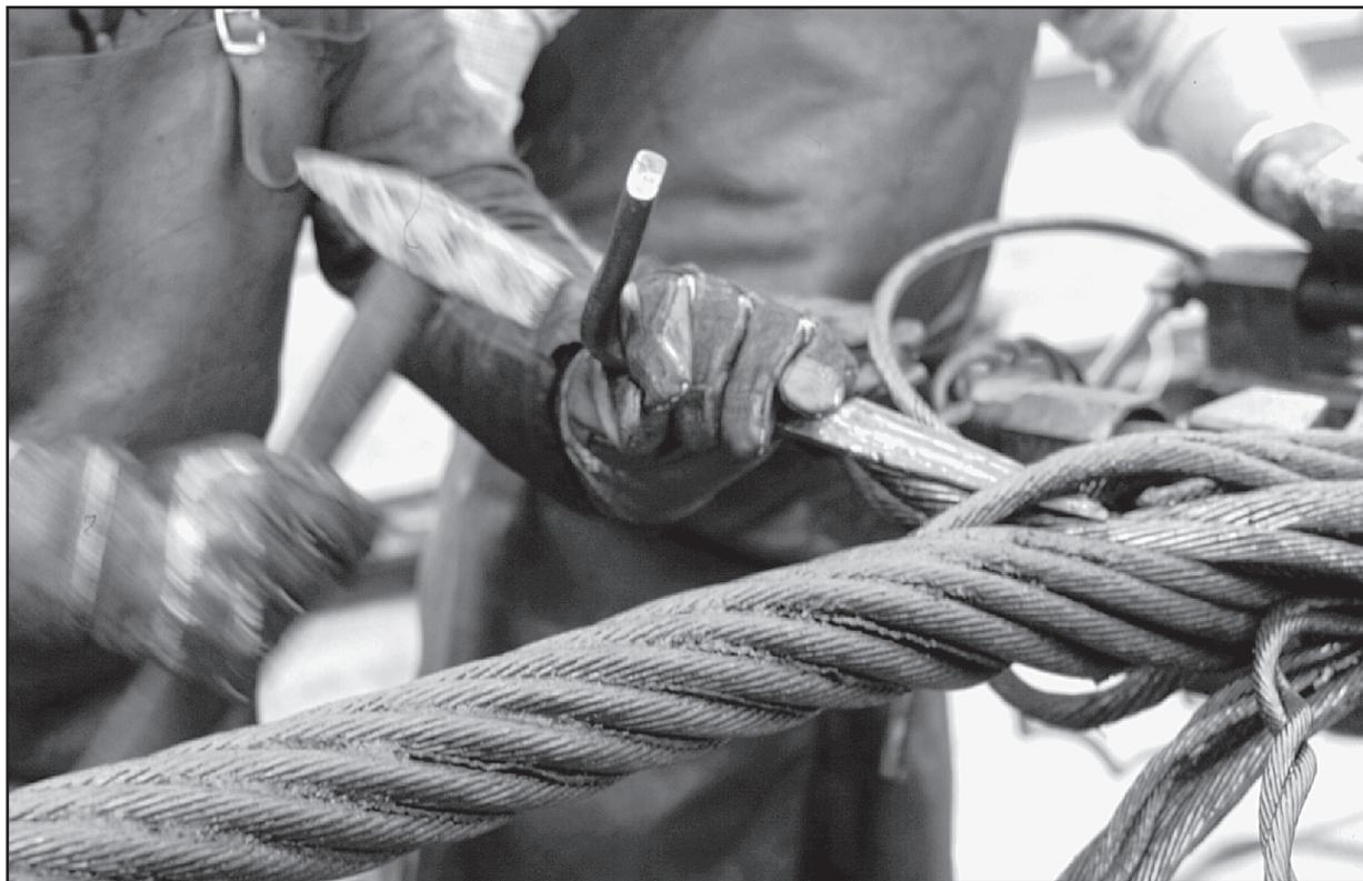
Fig. 31: Mise en place d'un épissoire au marteau
