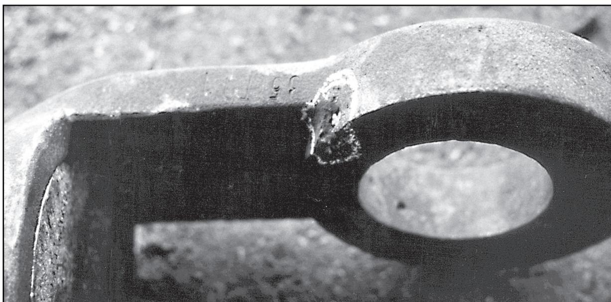
Fig. 67: Défaut de coulée sur un des bras de la chape d'un culot à chape femelle
