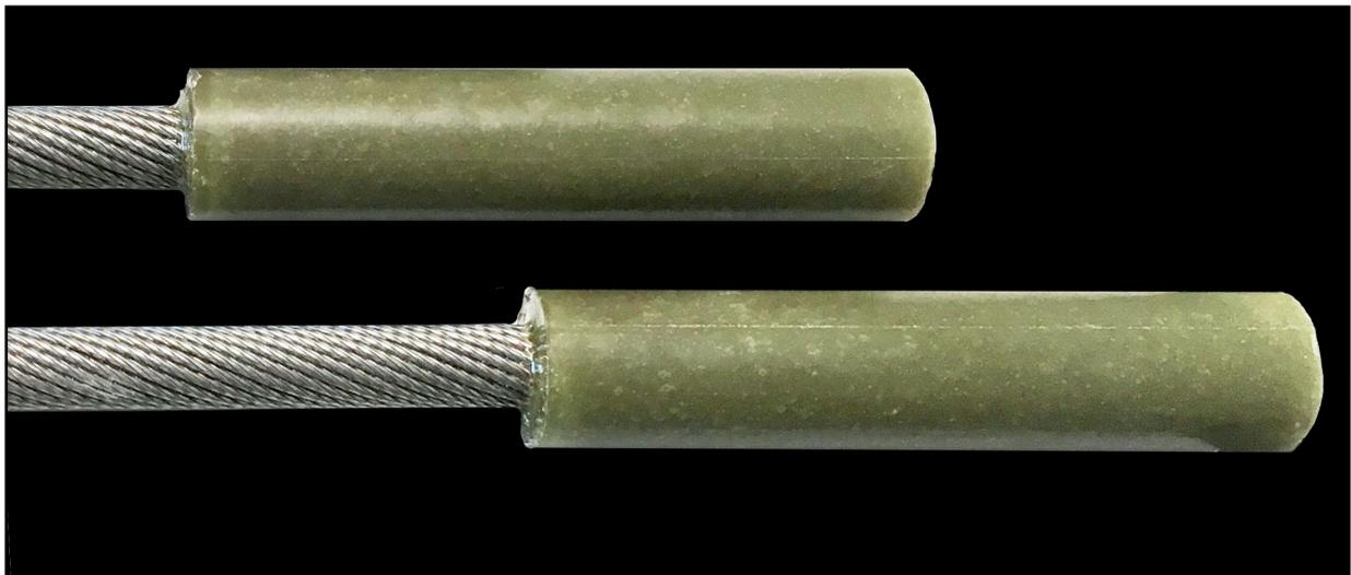
Fig. 88: Manchon coulé en résine Wirelock® réalisé sur un câble métallique
