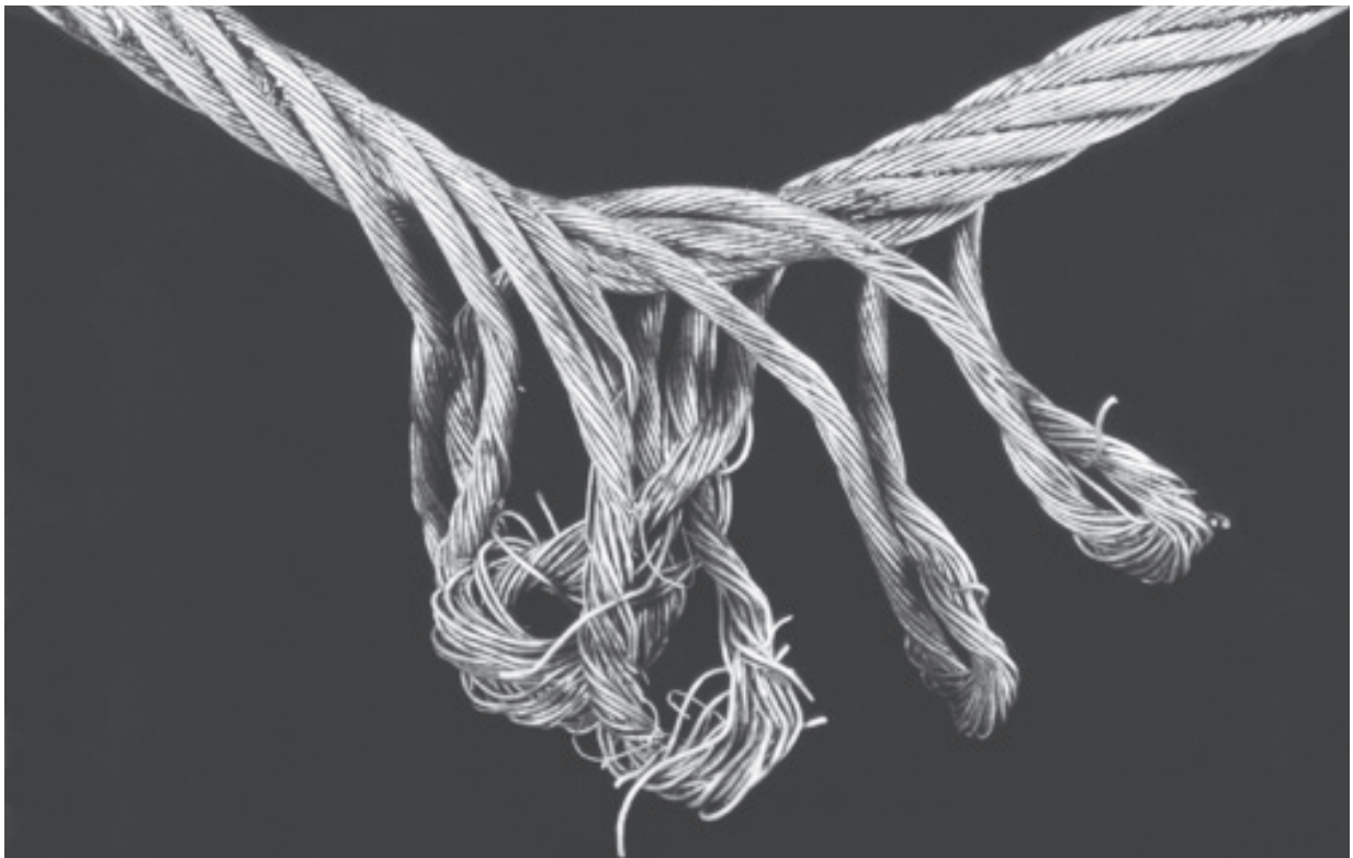
Fig. 39: Surlongueur des torons extérieurs causée par un détournage du câble.
