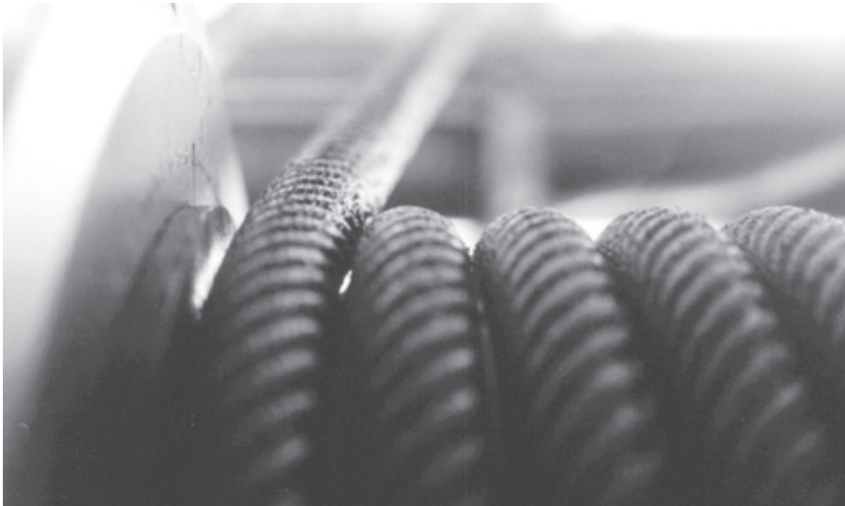
Fig. 46: A cause d'un angle de déflexion excessif, le câble est poussé contre la spire voisine. Les fils extérieurs sont endommagés dans les zones de contact.
