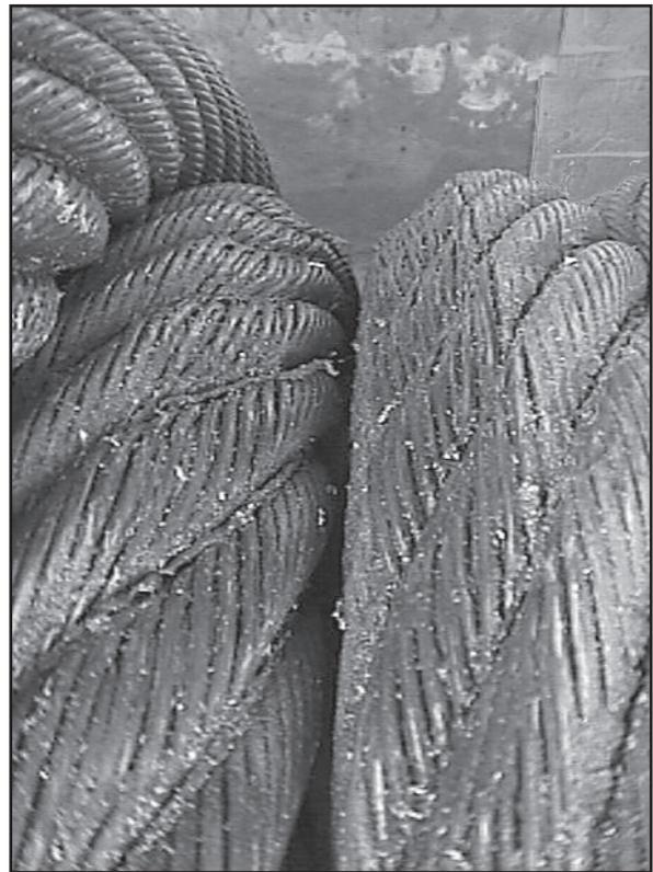
Fig. 26: Conséquences d'une interpénétration entre les couches.
