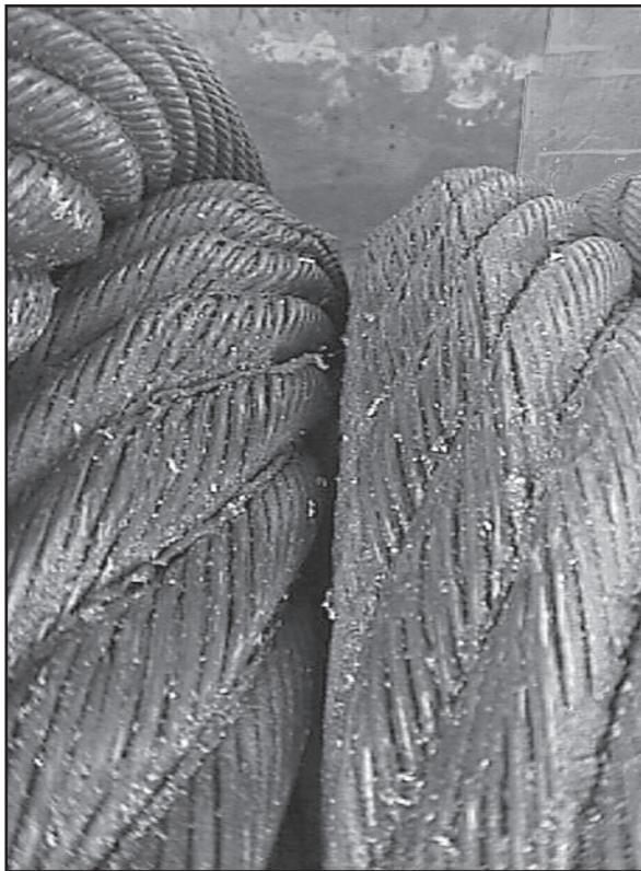
Fig. 25: D'importants mouvements relatifs ont détruit le câble lors de la première opération.
